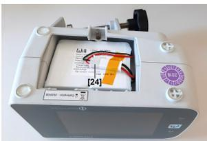
4. Замените крышку отсека аккумулятора и затяните винт (23).
